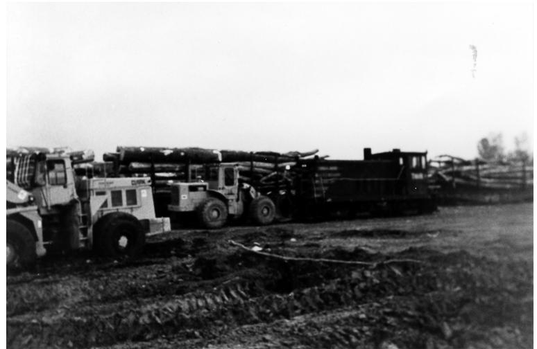
L'opérateur décharge la remorque du camion de son contenu de 30 mètres cubes avec une déchargeuse sur roues de 450 hp en ne brisant pas les piquets de la remorque et dépose le contenu du grappin sur la tronçonneuse.
