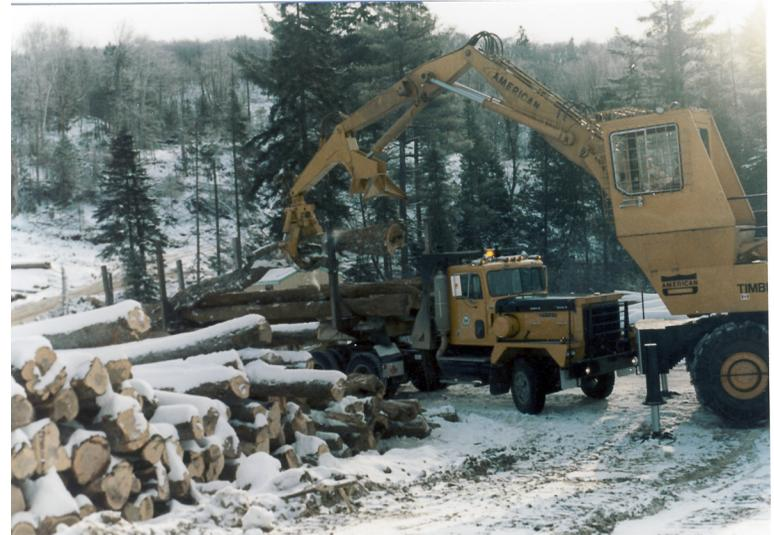
L'opérateur de la chargeuse avec la complicité de l'opérateur du camion charge la remorque avec attention pour que le chargement soit bien en place afin de ne pas perdre des arbres en longueur en cours de transport sur des chemins.
